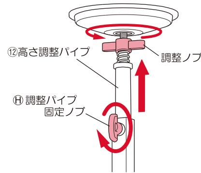
続いて⑫高さ調整パイプ上部の調整ノブを時計回りに回して天井との隙間をなくしガタつきがないよう確実に固定してください。
