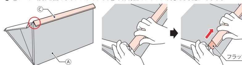
② 図のように①本体背面のフラップの★部分を強くつまみ、③レール(長)を引き抜きます。
