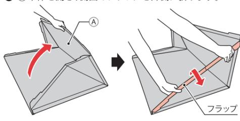
② フラップに②レール(短)を押し当てて取付けます。※反対側の側面も①②と同じ手順で取付けてください。
