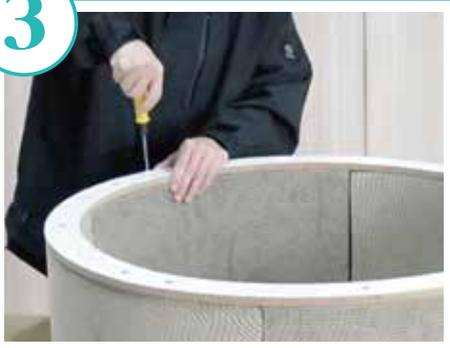
③位置が決まればホイールカバーの穴にプラスチックネジを入れ、付属ドライバーで4枚取付けます。
