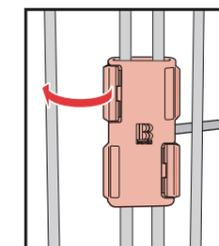
マイナスドライバー等をフック部の隙間に差し込み、破損しないよう慎重に押し開けてください。
