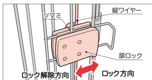
扉を180度開けた状態で扉ロックを左方向へスライドしツマミをワイヤーに引っかけて固定します。
